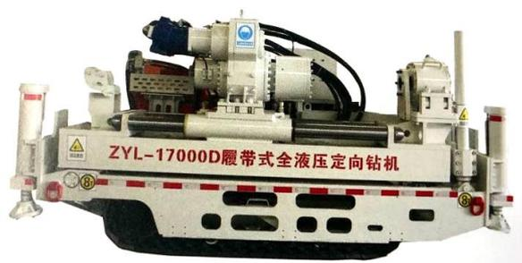
图 2 ZYL-17000D 型履带式全液压定向钻机
